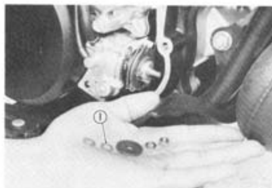
1. Adjusting shim 1. Cale de réglage 1. Einstellscheibe
