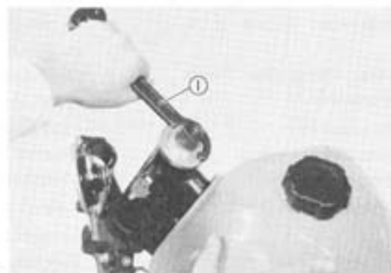
1. Stem bolt 1. Boulon 1. Lenkerschaftschraube
